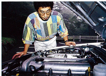
▲エンジンルームの点検。オイル、ラジエーター、ファンベルトの点検をする。
