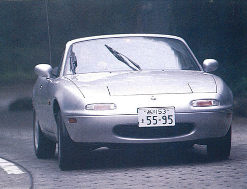
▲ブレーキングしながらコーナーに飛び込み、そのままブレーキングを残すと、フロントに荷重が移動してクルマの回頭性がよくなる。
