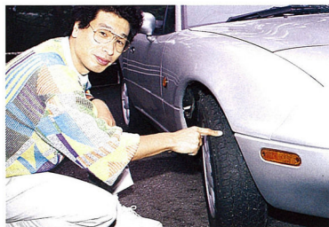
▲タイヤの点検。空気圧と摩耗を調べる。
