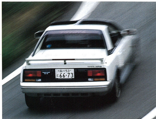
▲MR2のボディはTバールーフ型だが、ルーフパネルの着脱にもかかわらず、同一の走り味を示す。
