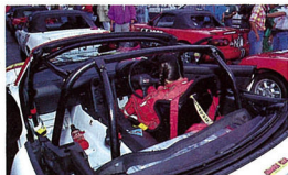
▲クルマはほとんど市販車そのまま。安全のために口コーバー、消火器を装備。シートはバケットシートで、ガッチリとからだをホールドする。
