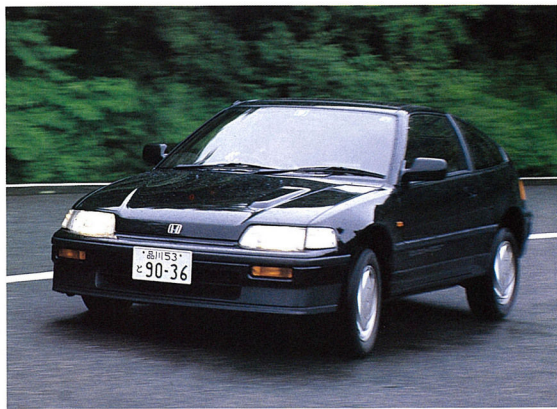
▲FFレイアウトのCR-Xの限界的なステアリング特性は大きめのアンダーステアリングである。
